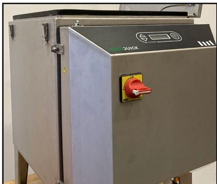
1. Coloque la unidad DESCONGELADORA a una altura adecuada para facilitar el acceso. Abra la tapa para desactivar el sensor de la tapa. **¡Asegúrese de que la máquina esté apagada!**
