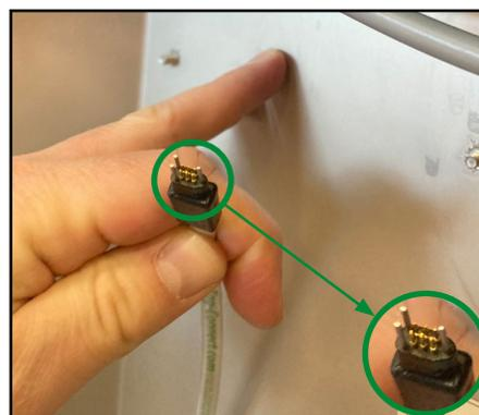
9. Asegúrese de que el conector de la herramienta de actualización esté colocado exactamente como se muestra en esta figura con dos puntos en el lado izquierdo.
