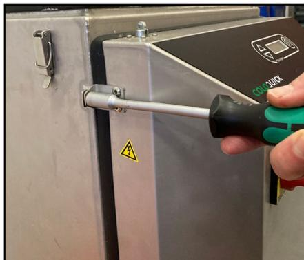
2. Retire las tuercas para desbloquear la puerta de servicio. **¡CUIDADOSO! ¡Peligro de descarga eléctrica al abrirlo! ¡APAGUE LA UNIDAD!**
