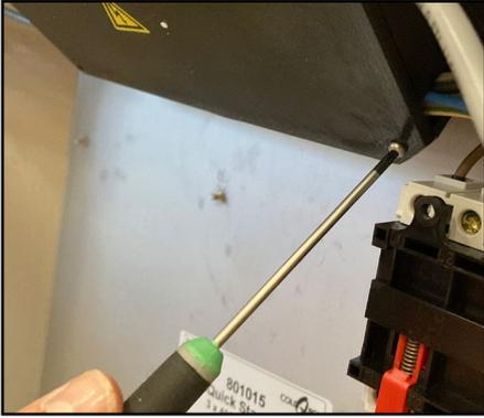
19. Vuelva a colocar la tapa de la caja negra con los cuatro tornillos.
