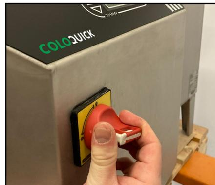
6. Encienda el equipo. Asegúrese de que haya agua en el tanque para evitar que el calentador se sobrecaliente.
