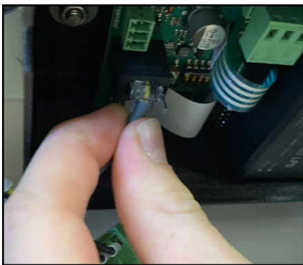
28. Plug in the transparent plug.
